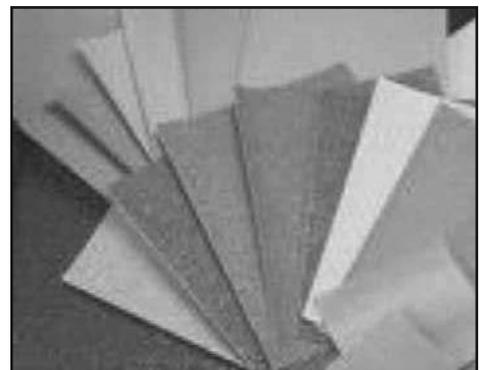
**Vendas:** se utilizan para la reparación de grietas o fisuras de gran tamaño o que estén localizadas en zonas sometidas a movimientos que puedan originar su reaparición.
